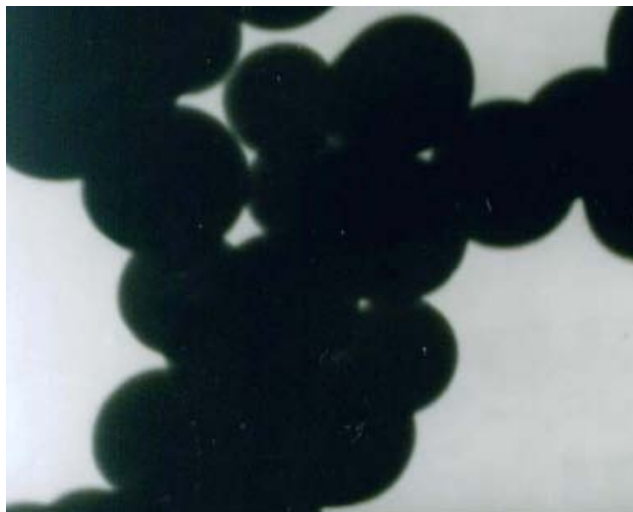
图 10 微球的透射电镜图片(2.5 万倍)
