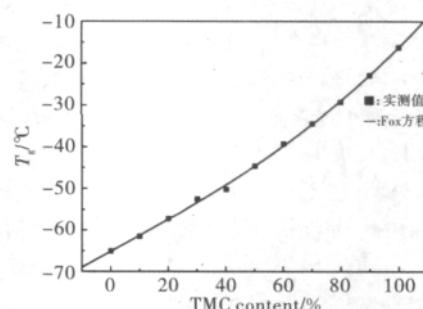
图2 P(TMC-co-CL)的玻璃化温度随TMC含量的变化曲线
