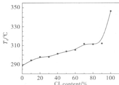
图 3 P(TMC-co-CL) 的热分解温度随 CL 含量的变化曲线
