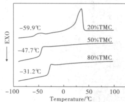
图1 P(TMC-co-CL)的DSC曲线
